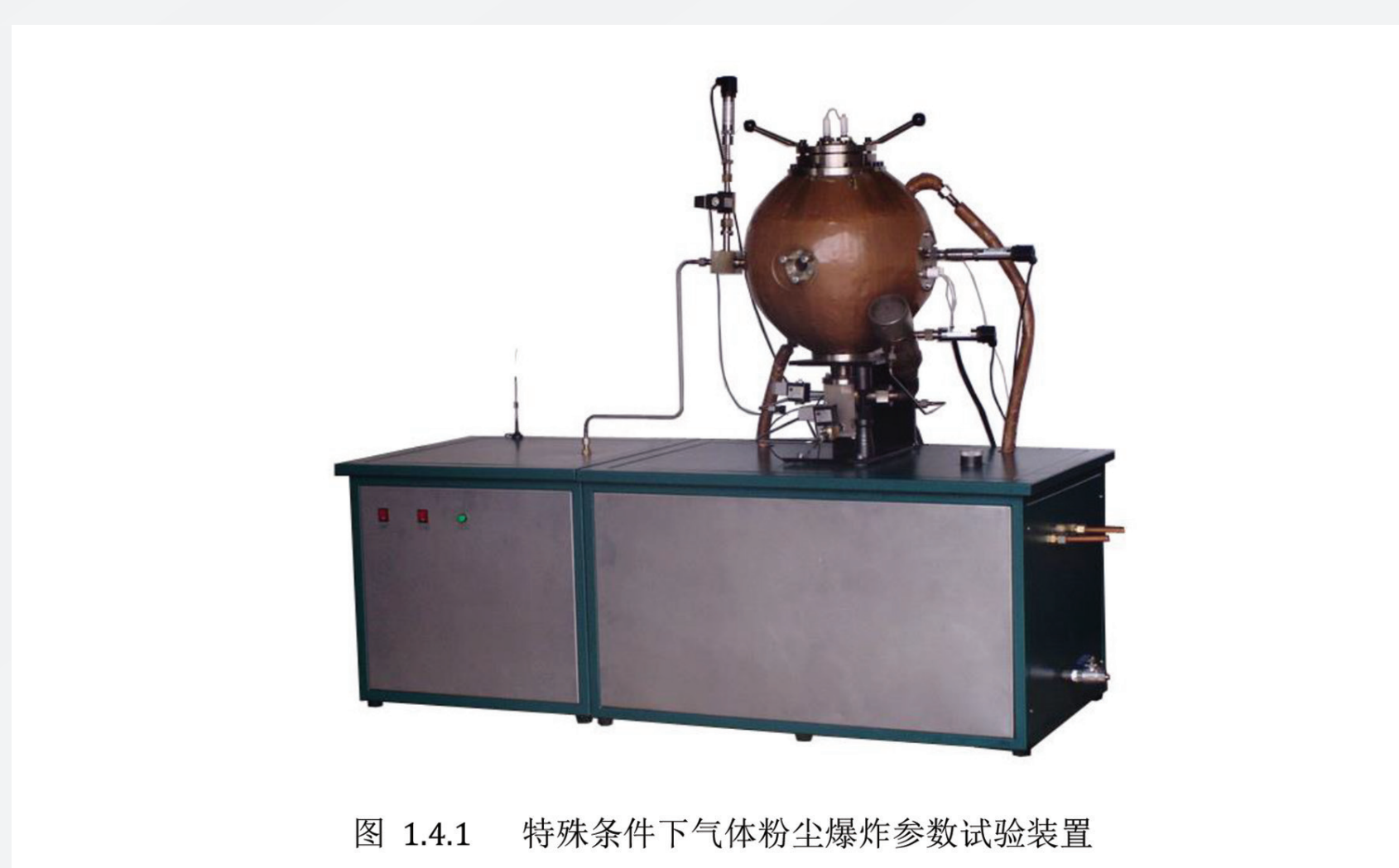
图 14.1 特殊条件下气体粉尘爆炸参数试验装置 Parameter test device for gas dust explosion under special conditions
